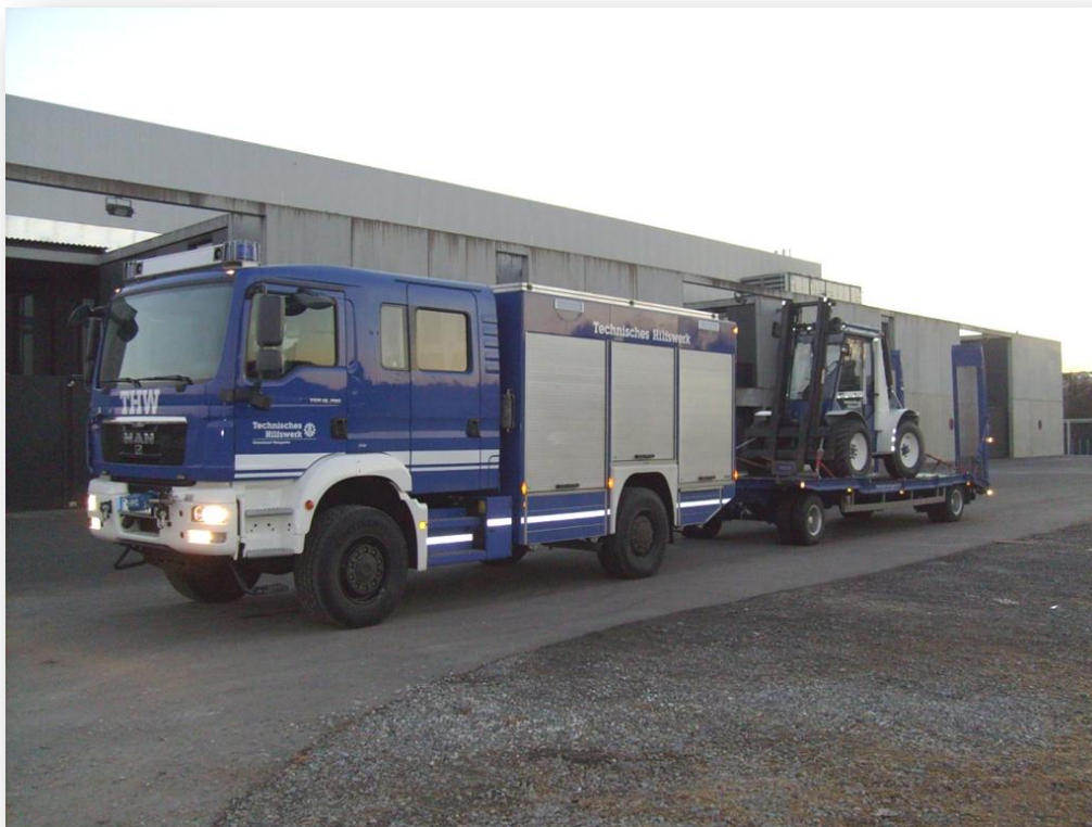
Bild 1: Gespann GKW 1 - MAN TGM 18.290 und Tieflader mit Geländestapler „Xelan 40“ Verladehöhe 3,80m - Gesamtlänge 16,80 m - Gesamtgewicht 27.000 kg
